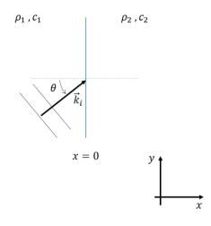
1. Considere una onda plana que incide sobre una interface plana entre dos medios como se muestra en la figura. La onda incidente produce una onda reflejada en el medio 1 y una onda transmitida en el medio 2 (a) Especifique las condiciones de borde que deben cumplir estas ondas en la interfase. (b) Muestre que se cumple la ley de reflexión y la ley de Snell. (c) Muestre que ni la onda reflejada ni la onda transmitida tiene componente del vector de ondas en la dirección z. (c) Halle los
