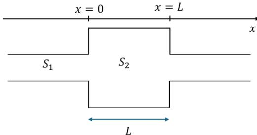
**Ejercicio 1.** Considere una onda que se propaga desde la izquierda en un tubo de bordes rígidos de sección transversal  $S_1$ . El tubo tiene un ensanchamiento de sección  $S_2 = 5S_1$  y largo  $L$  como se muestra en la figura. En el límite de bajas frecuencias ( $\lambda \gg S_1^{1/2}; S_2^{1/2}$ ), el coeficiente de reflexión está dado por:
