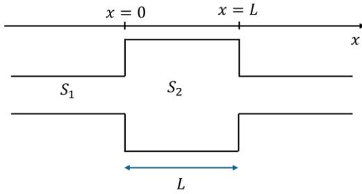
**Ejercicio 1.** Considere una onda que se propaga desde la izquierda en un tubo de bordes rígidos de sección transversal  $S_1$ . El tubo tiene un ensanchamiento de sección  $S_2 = 5S_1$  y largo  $L$  como se muestra en la figura. En el límite de bajas frecuencias ( $\lambda \gg S_1^{1/2}; S_2^{1/2}$ ), el coeficiente de reflexión está dado por:
