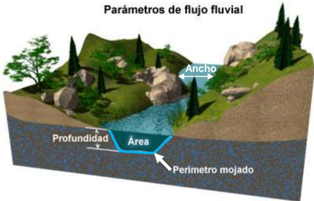
$$\text{Radio hidráulico} = \frac{\text{Área}}{\text{Perímetro mojado}} = \frac{A = \pi r^2}{P = 2 \cdot \pi \cdot r}$$
