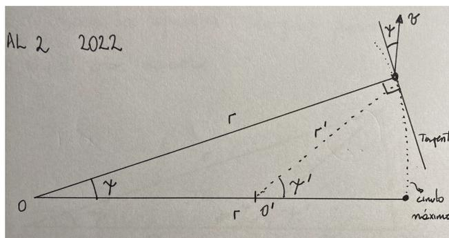
Consideramos la siguiente figura con el observador en  $O$ . Para el caso de una estrella cualquiera, la velocidad radial  $v_{rad}$  y el movimiento propio  $\mu$  vienen dados por  $v_{rad} = v \sin \Psi$  y  $\mu = \frac{v}{r} \cos \Psi$ . Si ahora el observador se desplaza a  $O'$ , acercándose a la estrella, tendremos  $v'_{rad} = v \sin \Psi'$  y  $\mu' = \frac{v}{r'} \cos \Psi'$ .
