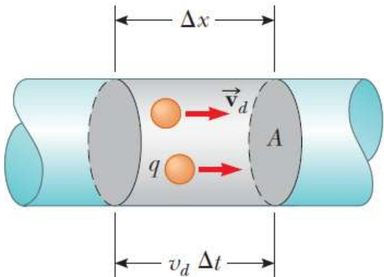
$n$ : portadores de carga móviles por unidad de volumen (**densidad de portadores de carga**).
