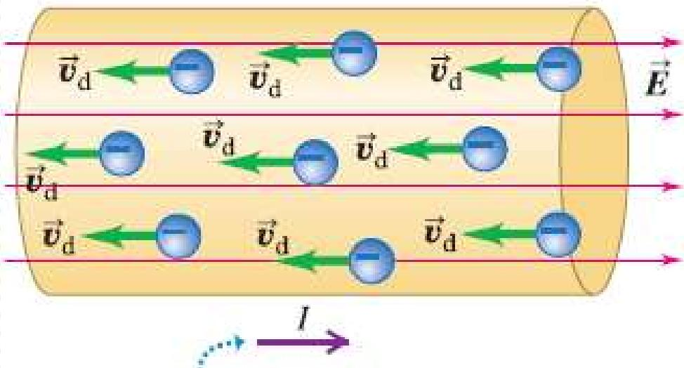
En un conductor metálico, las cargas en movimiento son electrones, pero la corriente aún apunta en la dirección en que fluirían las cargas positivas.
