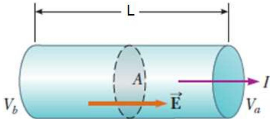
Conductor uniforme de longitud  $L$  y área de sección transversal  $A$ .
