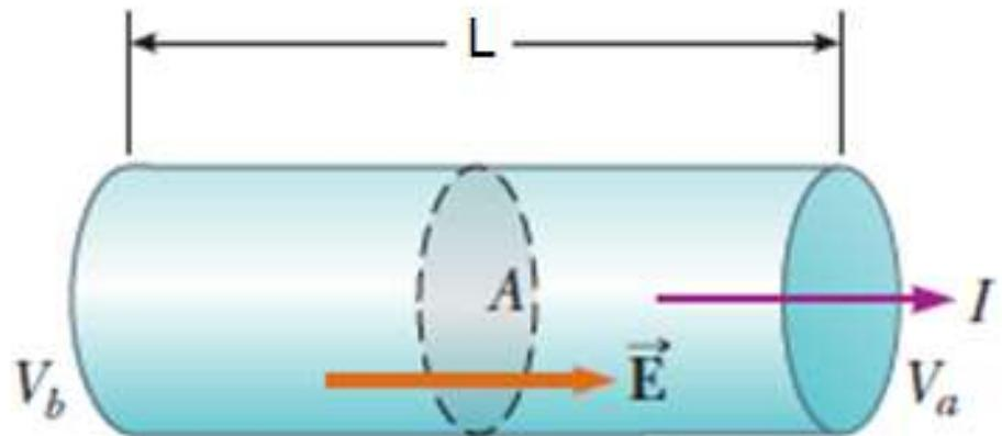
Conductor uniforme de longitud  $L$  y área de sección transversal  $A$ .
