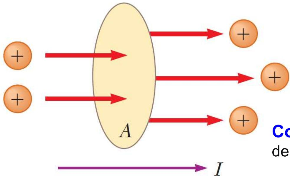
**Corriente eléctrica** a través de un área de sección transversal  $A$  es *la carga neta que fluye a través del área por unidad de tiempo*:
