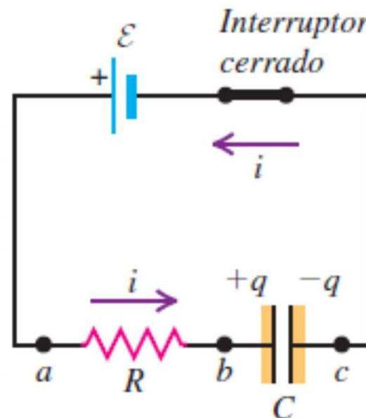
Quando el interruptor se cierra, a medida que transcurre el tiempo, la carga en el capacitor se incrementa y la corriente disminuye.
