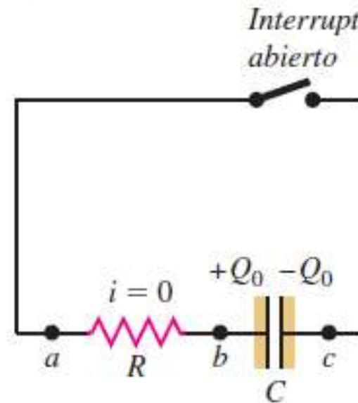
b) Descarga del capacitor
