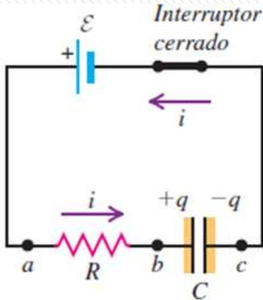
A medida que el capacitor se carga, su voltaje  $v_{bc}$  aumenta, mientras que el voltaje del resistor  $v_{ab}$ , disminuye, cumpliéndose siempre que:  $\mathcal{E} = v_{ab} + v_{bc}$ .
