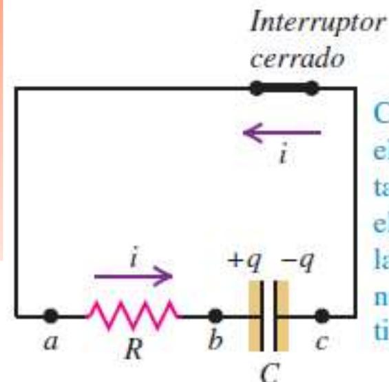
Cuando se cierra el interruptor, tanto la carga en el capacitor como la corriente disminuyen con el tiempo.
