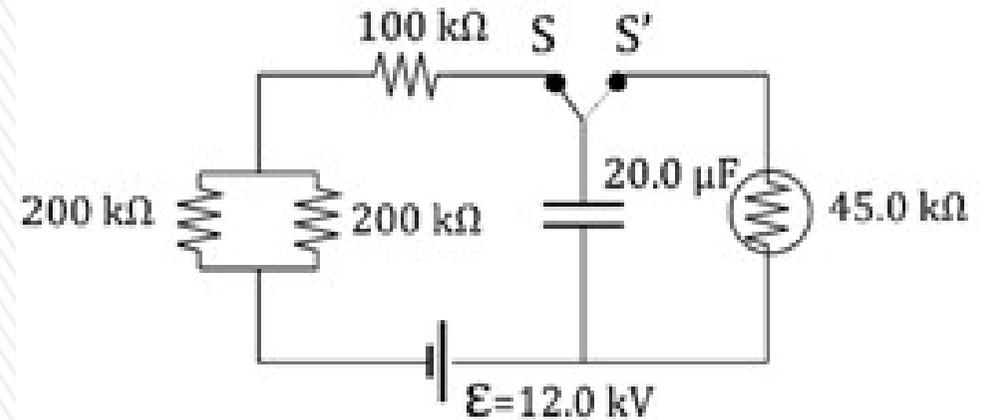
Carga del capacitor en  $t = 8,00 \text{ s}$   $q(t) = \mathcal{E}C \left( 1 - e^{-\frac{t}{R_{eq}C}} \right)$
