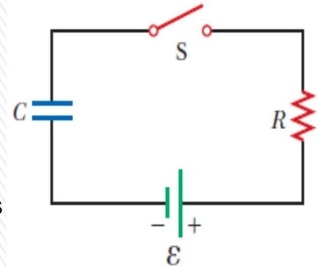
d) Carga como función del tiempo:  $q(t) = Q \left( 1 - e^{-\frac{t}{RC}} \right)$
