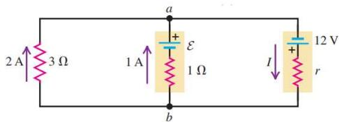
a) Calcule la corriente  $I$  a través de la fuente de poder, la resistencia  $r$  y la fem  $\mathcal{E}$ .
