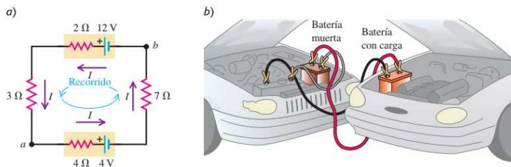
(figura b). La batería descargada se carga ligeramente en el proceso. Los resistores de  $3 \Omega$  y  $7 \Omega$  de la figura a) representan las resistencias de los cables para pasar corriente y de la trayectoria de conducción a través del automóvil con la batería descargada. (Los valores de las resistencias reales de los automóviles y cables para pasar corriente son considerablemente menores).
