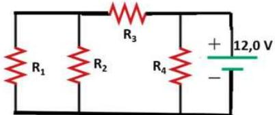
**2.1.20- Examen marzo 2025** – Se arma un circuito eléctrico compuesto por resistencias conectadas según se muestra en la figura, con  $R_1 = 4,00 \Omega$ ,  $R_2 = 6,00 \Omega$  y  $R_3 = 12,0 \Omega$ . El circuito disipa una potencia total de 18,0 W cuando se conecta a la fuente de 12,0 V. Determine el valor de la resistencia  $R_4$ .
