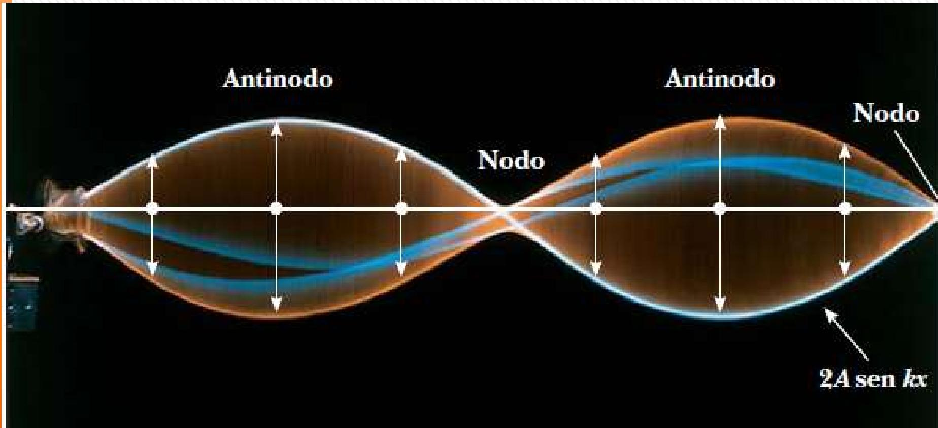
Fotografía múltiple de una onda estacionaria en una cuerda. El comportamiento temporal del desplazamiento vertical desde el equilibrio de un elemento individual de la cuerda se conoce por  $\cos \omega t$ . Es decir, cada elemento vibra con una frecuencia angular  $\omega$ . La amplitud de la oscilación vertical de cualquier elemento de la cuerda depende de la posición horizontal del elemento. Cada elemento vibra dentro de los confines de la función envolvente  $2A \operatorname{sen} kx$ .
