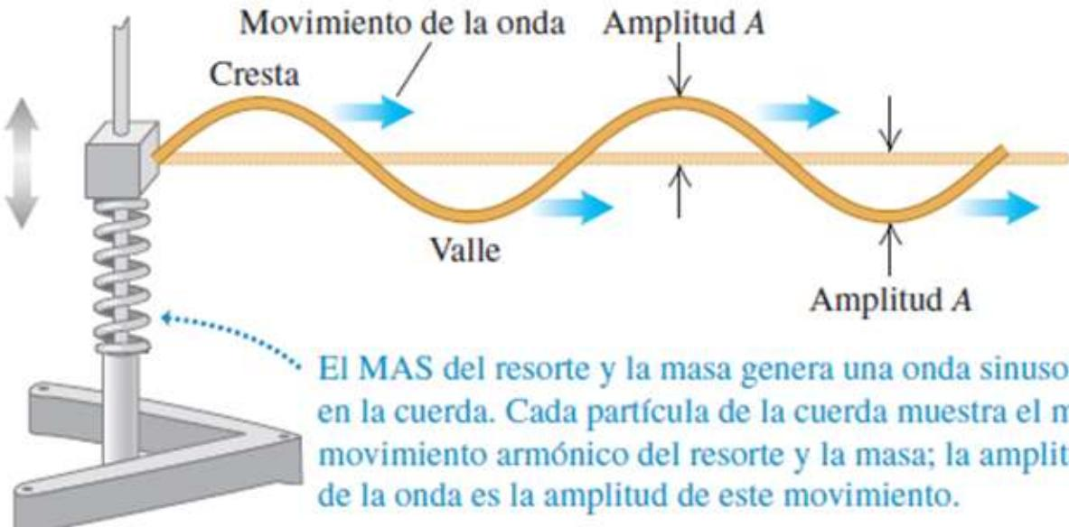
El MAS del resorte y la masa genera una onda sinusoidal en la cuerda. Cada partícula de la cuerda muestra el mismo movimiento armónico del resorte y la masa; la amplitud de la onda es la amplitud de este movimiento.
