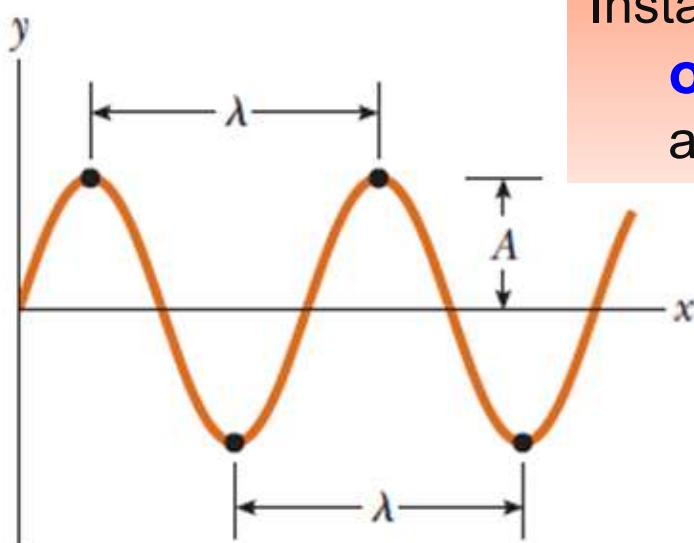
Instantánea (foto) de una onda sinusoidal. La **longitud de onda  $\lambda$**  es la distancia entre crestas o valles adyacentes.
