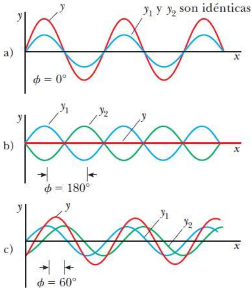
Superposición de dos ondas idénticas  $y_1$  e  $y_2$  (azul y verde, respectivamente) para producir una onda resultante (rojo).
