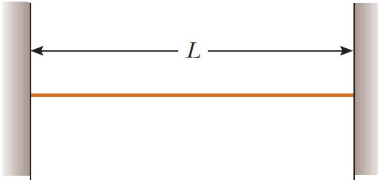
Cuerda de longitud  $L$  fija en ambos extremos: modelo p/ cuerda de guitarra o piano.
