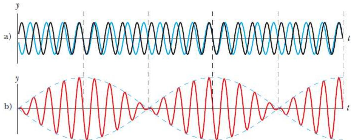
Superposición de dos ondas de igual amplitud que viajan a través de un medio con frecuencias ligeramente diferentes  $f_1$  y  $f_2$ ; la **onda resultante** tiene una frecuencia efectiva igual a la **frecuencia promedio**  $(f_1 + f_2)/2$  multiplicada por una **onda envolvente**
