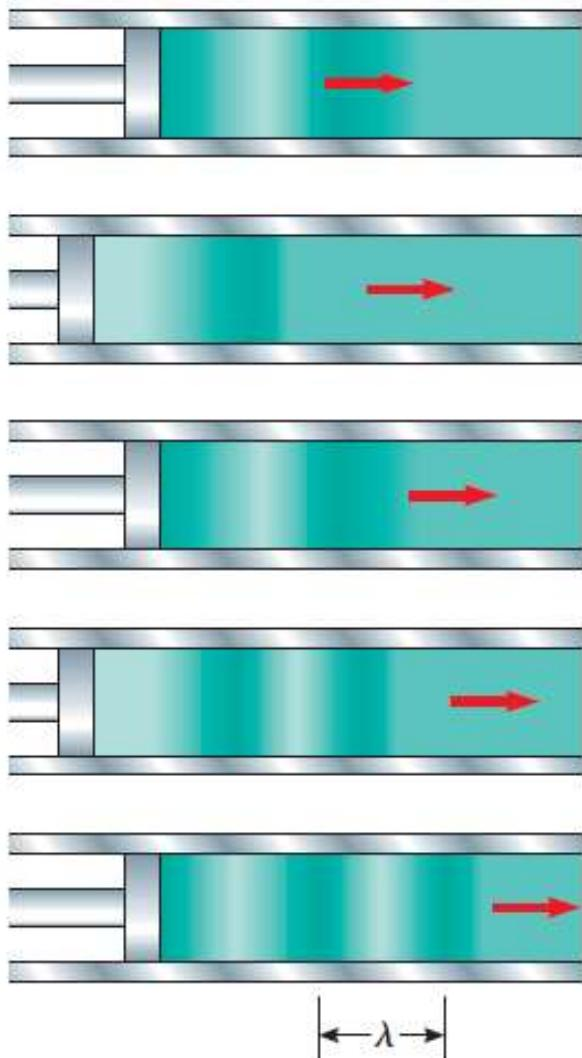
Onda sonora periódica unidimensional en tubo con gas, generado por pistón en oscilación en un extremo. Región comprimida se forma cuando el pistón empuja en el tubo, se mueve a través del tubo, y comprime continuamente la región justo enfrente de ella misma. Cuando el pistón retrocede, el gas enfrente de él se expande y la presión y la densidad en esta región caen por abajo de sus valores de equilibrio (**enrarecimiento**). Ambas regiones se mueven a la rapidez del sonido en el medio.
