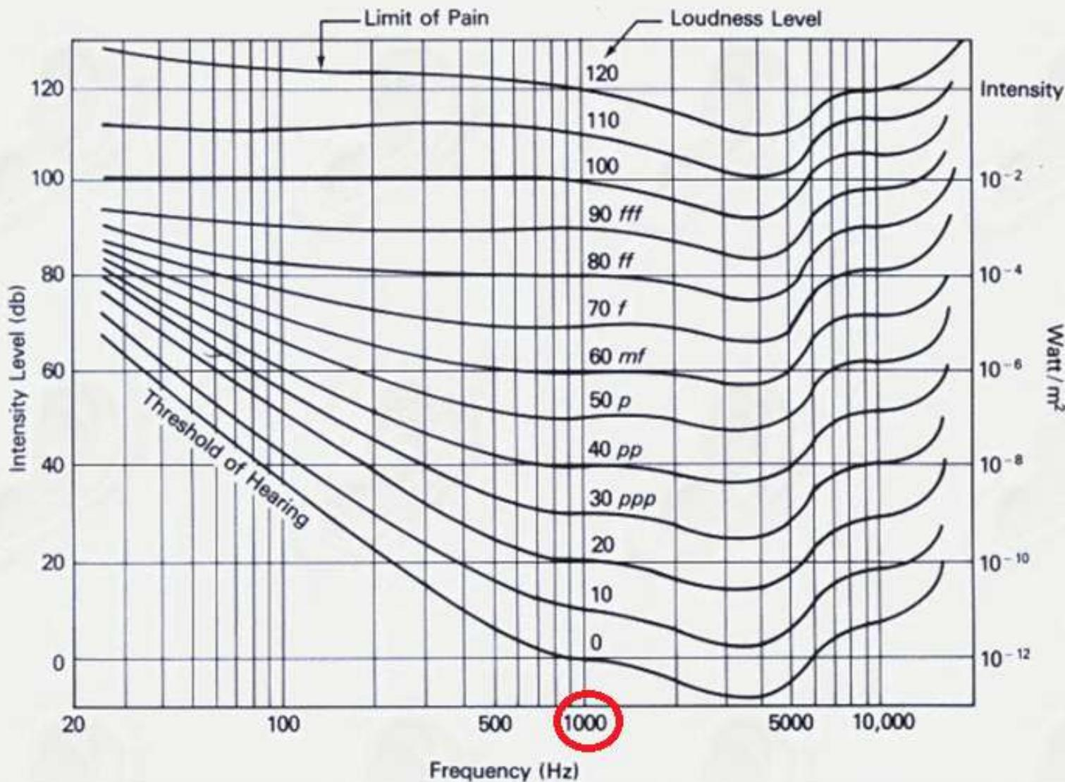
**Umbral de audición:** intensidad mínima necesaria para que un sonido de una frecuencia dada empiece a ser audible (curva inferior).
