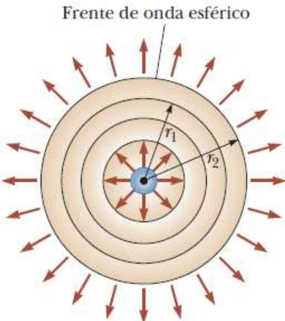
Si un pequeño objeto esférico oscila de manera que su radio cambia periódicamente, se produce una **onda esférica**.
