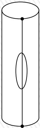
Los modos normales para un tubo con ambos extremos cerrados, son iguales a los correspondientes a uno con ambos extremos abiertos, ya que tiene un nodo en c/u de los extremos, por lo que la longitud de onda del primer modo vale:  $\lambda_1=2L$  (igual que cuando ambos extremos están cerrados).
