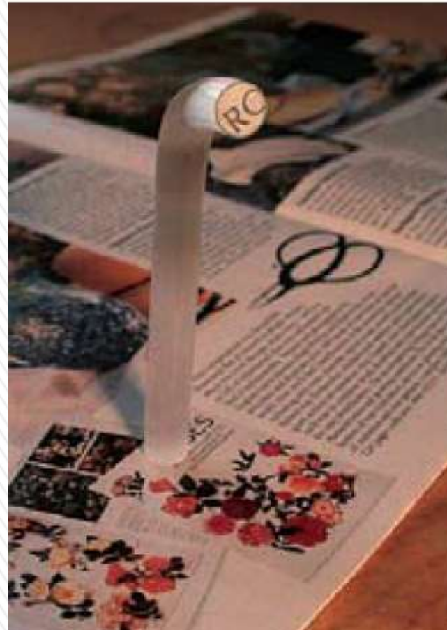
33.16 Transmisión de imágenes por un haz de fibras ópticas.
