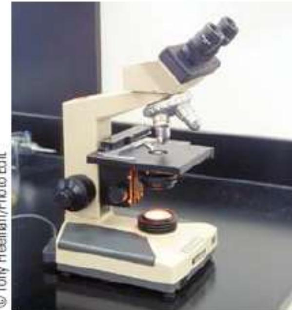
El microscopio compuesto <sup>a)</sup> está constituido por una lente, el **objetivo**, que tiene una distancia focal muy corta, menor a 1 cm, y <sup>b)</sup> una segunda lente, el **ocular**, que tiene una distancia focal de unos cuantos centímetros.
