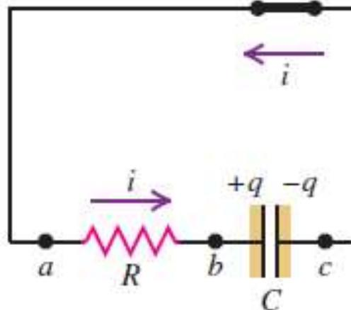
Cuando se cierra el interruptor, tanto la carga en el capacitor como la corriente disminuyen con el tiempo.
