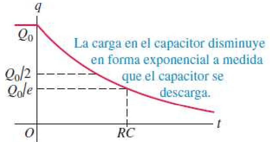
En un circuito cuando tengo un capacitor totalmente descargado el mismo se comporta como un cable, mientras que cuando esté totalmente cargado actúa como un interruptor abierto.
