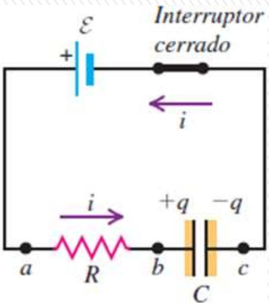
A medida que el capacitor se carga, su voltaje  $v_{bc}$  aumenta, mientras que el voltaje del resistor  $v_{ab}$ , disminuye, cumpliéndose siempre que:  $\mathcal{E} = v_{ab} + v_{bc}$ .
