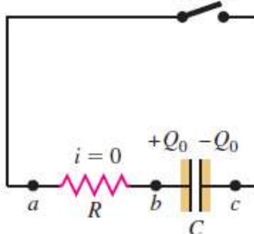
b) Descarga del capacitor
