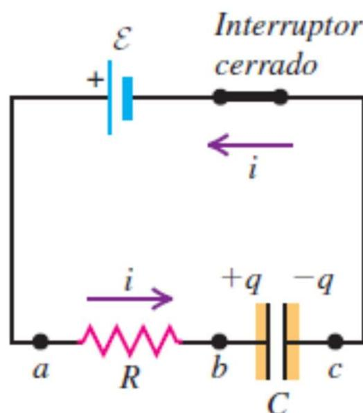
Cuando el interruptor se cierra, a medida que transcurre el tiempo, la carga en el capacitor se incrementa y la corriente disminuye.
