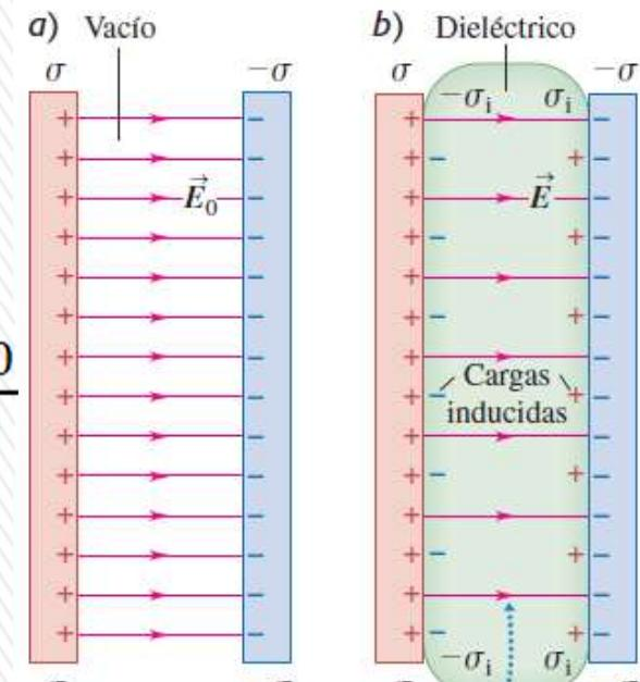
Para una densidad de carga determinada  $\sigma$ , las cargas inducidas en las superficies del dieléctrico reducen el campo eléctrico entre las placas.
