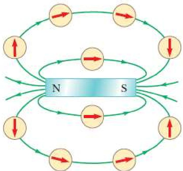
Espacio que rodea a cualquier sustancia magnética (imán permanente) o a cualquier carga eléctrica *en movimiento* contiene un **campo magnético (B)**.
