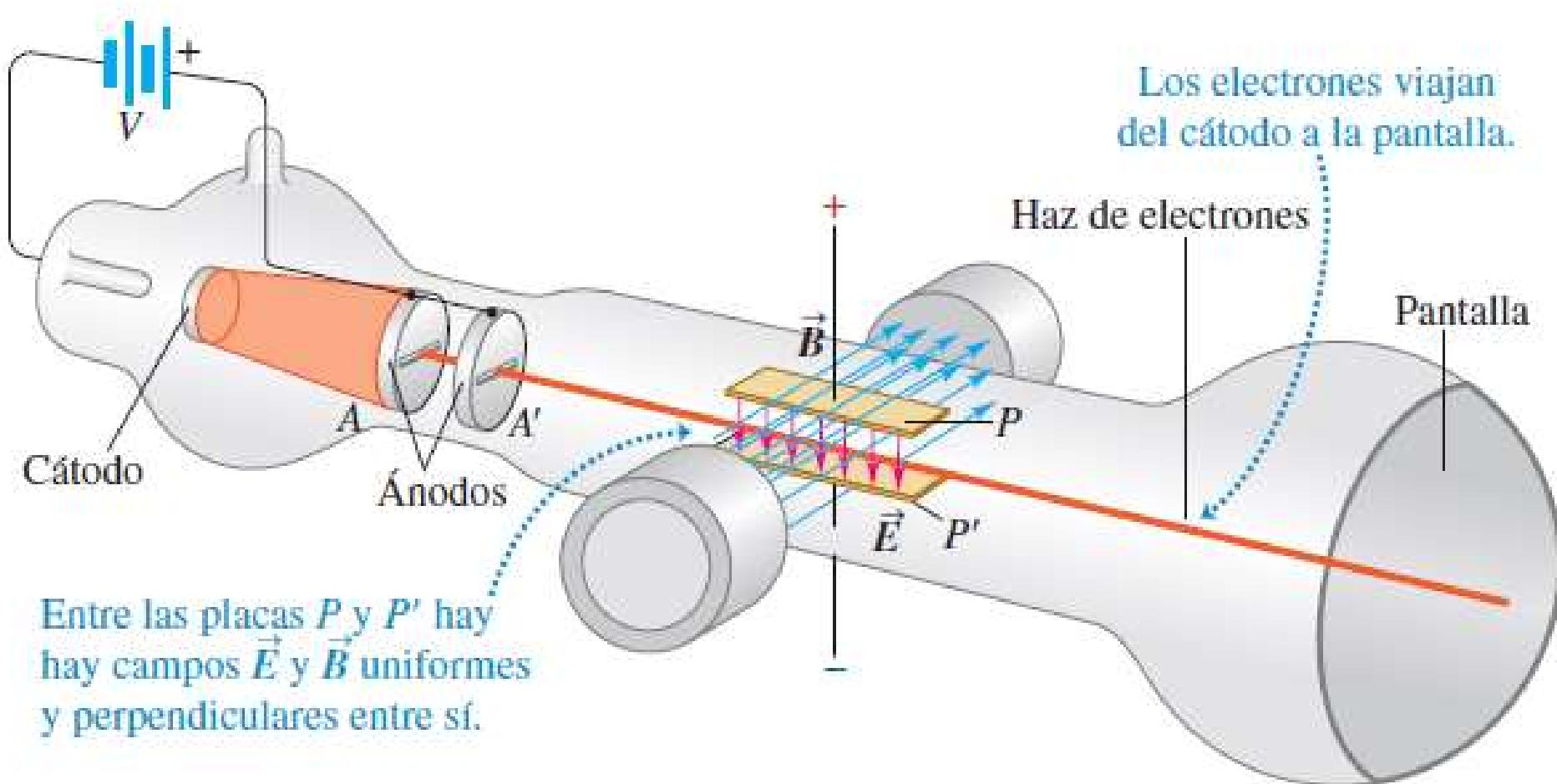
En 1897 J.J. Thomson realizó uno de los experimentos cruciales de la física basándose en la idea anterior y midió la razón  $e/m$  que hay entre la carga y la masa del electrón. En un contenedor de vidrio al alto vacío se aceleraron electrones provenientes de un cátodo caliente, para formar un haz mediante una diferencia de potencial  $V$  entre los dos ánodos  $A$  y  $A'$ . La rapidez  $v$  de los electrones estaba determinada por el potencial acelerador  $V$ .
