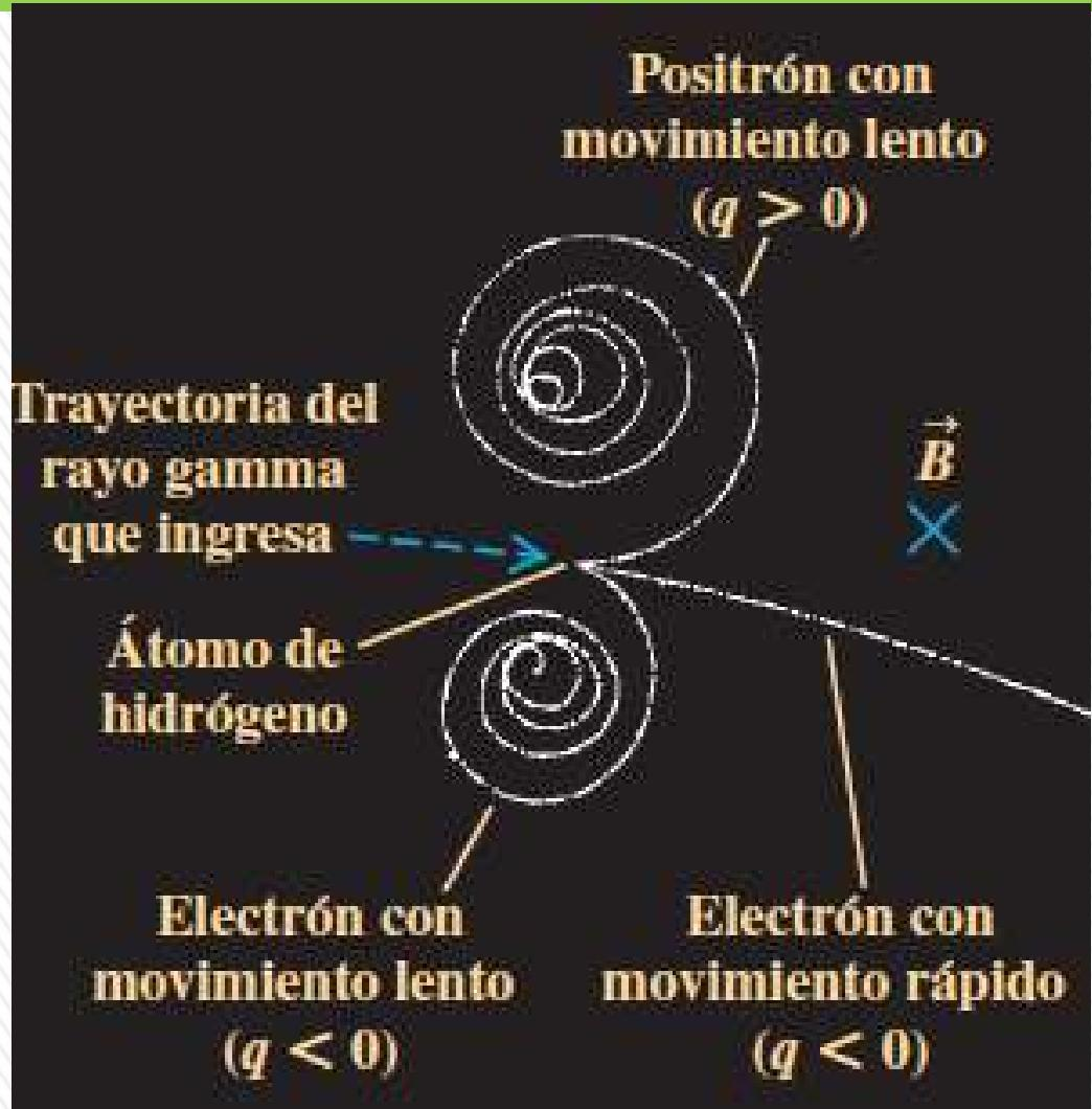
Cámara llena de hidrógeno líquido y con un  $B$  entrante
