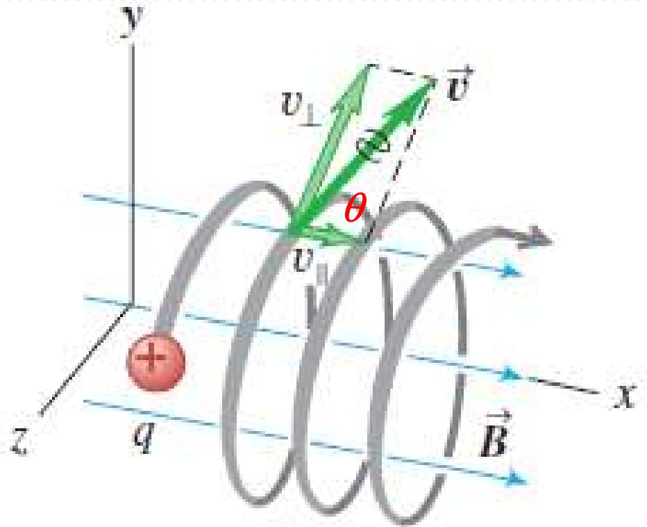
Si la dirección de la velocidad inicial *no* es perpendicular al campo, la componente de la velocidad paralela al campo es constante porque no hay fuerza paralela al campo. Así que la partícula se mueve en un patrón **helicoidal**.
