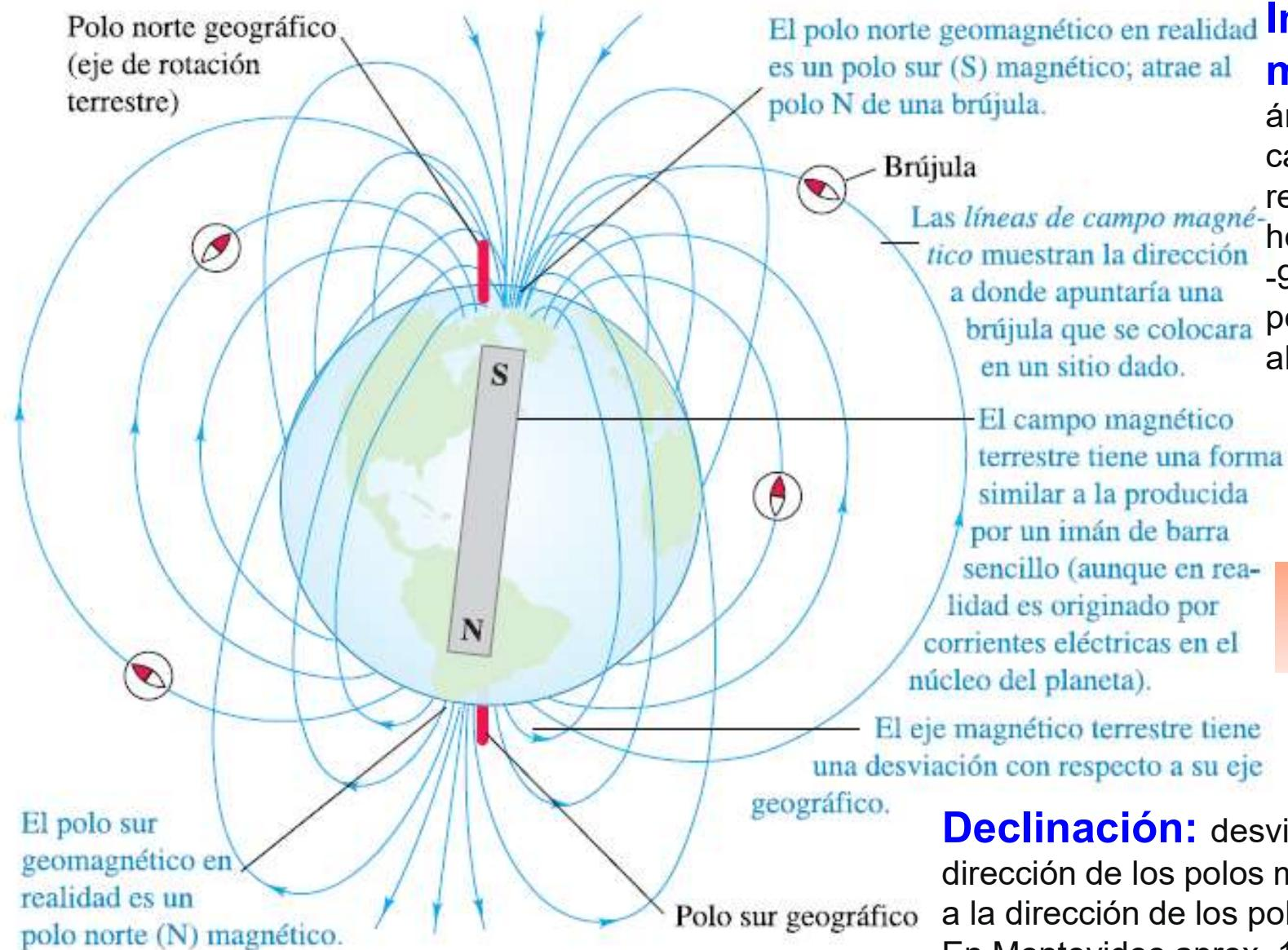
**Inclinación magnética:** ángulo que forma el campo magnético respecto a un plano horizontal. Varía entre  $-90^\circ$  (hacia arriba en el polo sur) y  $90^\circ$  (hacia abajo, en el polo norte)
