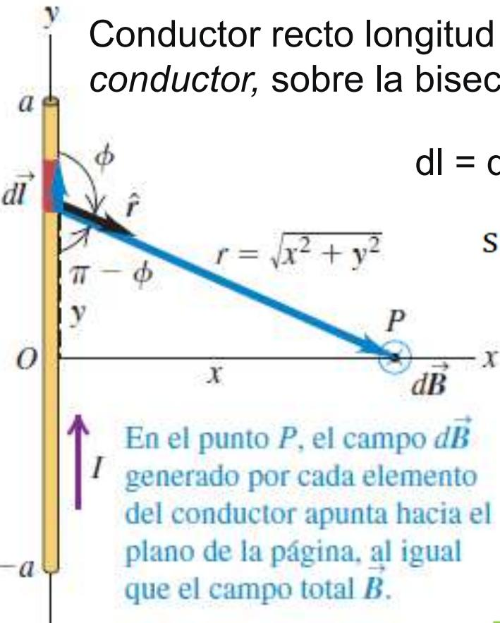
Conductor recto longitud  $2a$  con corriente  $I$ , campo en punto a distancia  $x$  del conductor, sobre la bisectriz perpendicular.
