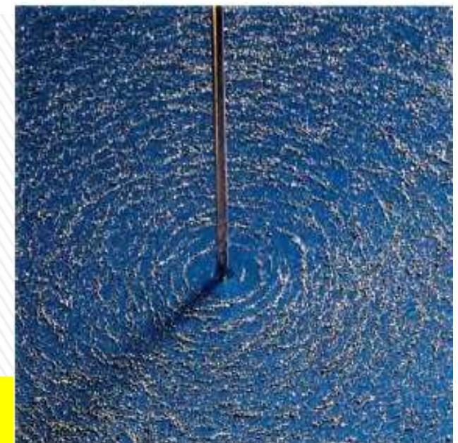
**ATENCIÓN:** Si bien este resultado es exacto sólo si la longitud del alambre es infinito, se puede usar como buena aproximación cuando la distancia donde se calcula el campo es mucho menor que la longitud del alambre y se desprecian los efectos de borde.
