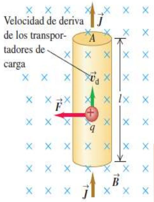
Segmento rectilíneo alambre conductor, de longitud  $l$  y área  $A$ ; la corriente  $I$  va de abajo hacia arriba.
