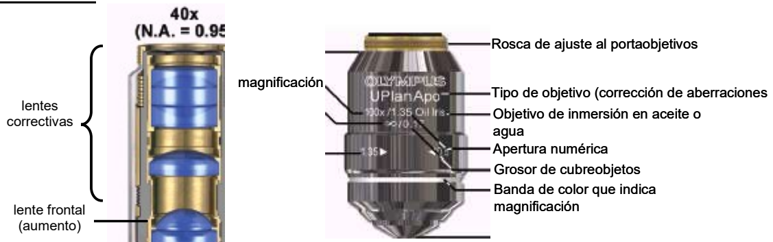
Figura 2: Complejidad de una lente objetiva y nomenclatura estándar. (Modificado de www.olympusmicro.com )
