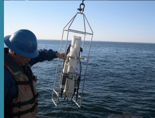
Costero-Oceanográfico CTD (Conductividad, Temperatura, Profundidad)
