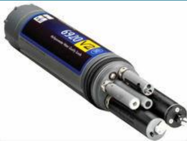
Costero-Oceanográfico CTD (Conductividad, Temperatura, Profundidad)
