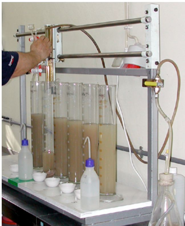
Fig. 24 -Bateria de pipetagem existente no CIACOMAR (Univ. Algarve).
