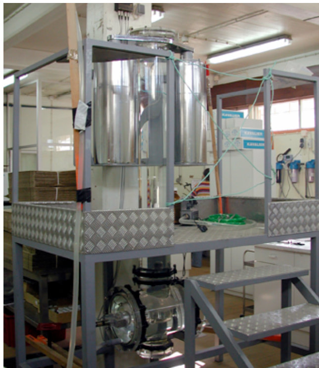
Fig. 16 - Tubo de sedimentação (MacroGranometer) existente no CIACOMAR (Univ. Algarve),
