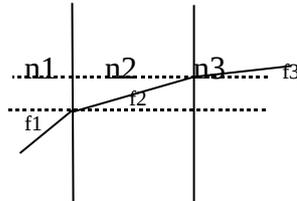
Si tenemos una placa de ancho  $L$  con un índice de refracción variable  $n(x)$ , podemos subdividir el ancho de la placa en intervalos iguales y considerar el índice de refracción en cada intervalo como constante. Cuanto menor sea el intervalo mejor será la aproximación:
