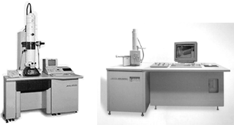
Figura 2: Microscopios electrónicos de transmisión (izquierda) y de barrido (derecha)
