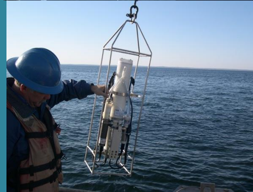
Costero-Oceanográfico CTD (Conductividad, Temperatura, Profundidad)
