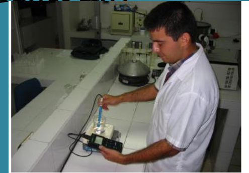
Equipo pHmetro WTW. Utilizado para medir el pH en laboratorio y en campo
