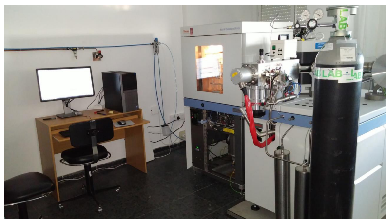
Fig. 3. Espectrómetro para la medición de relaciones isotópicas (Laboratorio de isótopos estables de la Universidad Complutense de Madrid).
