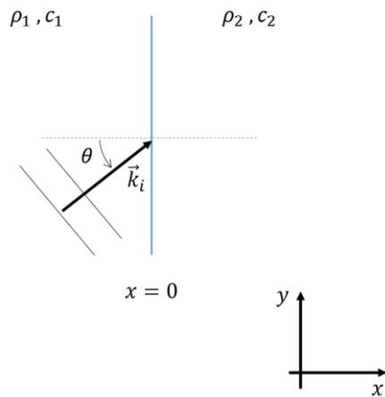
1. Considere una onda plana que incide sobre una interfaz plana entre dos medios como se muestra en la figura. La onda incidente produce una onda reflejada en el medio 1 y una onda transmitida en el medio 2 (a) Especifique las condiciones de borde que deben cumplir estas ondas en la interfase. (b) Muestre que se cumple la ley de reflexión y la ley de Snell. (c) Muestre que ni la onda reflejada ni la onda transmitida tiene componente del vector de ondas en la dirección  $z$ . (c) Halle los
