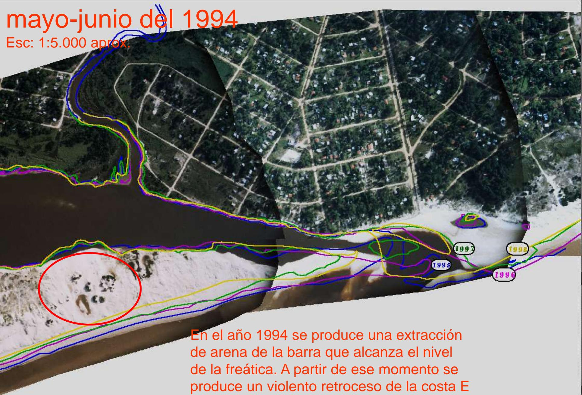
En el año 1994 se produce una extracción de arena de la barra que alcanza el nivel de la freática. A partir de ese momento se produce un violento retroceso de la costa E
