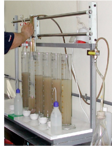
Fig. 24 - Bateria de pipetagem existente no CIACOMAR (Univ. Algarve).
