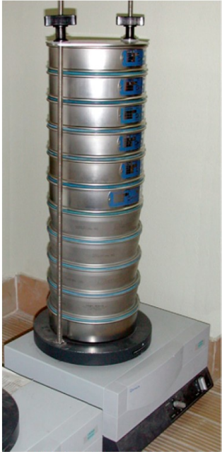
Fig. 15 - Agitador de peneiros e coluna de peneiração utilizados no CIACOMAR (Univ. Algarve).
