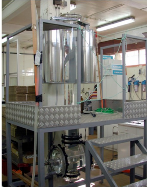
Fig. 16 - Tubo de sedimentação (MacroGranometer) existente no CIACOMAR (Univ. Algarve),
