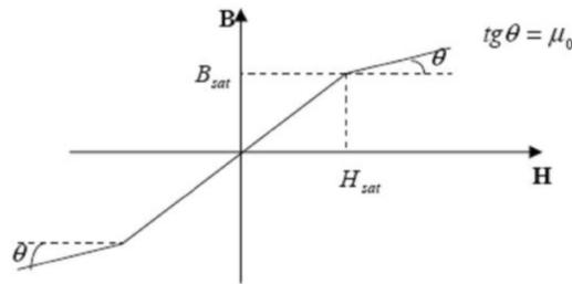
$$\begin{aligned} \vec{B}(\vec{H}) &= \mu \vec{H} && \text{si } |\vec{H}| < H_{sat} \\ \vec{B}(\vec{H}) &= \vec{B}_{sat} + \mu_0(\vec{H} - \vec{H}_{sat}) && \text{si } |\vec{H}| > H_{sat} \\ \text{con } \mu &= \left| \frac{\vec{B}_{sat}}{\vec{H}_{sat}} \right| \end{aligned}$$
